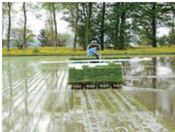
自動操舵システムによる「無落水移植栽培」
